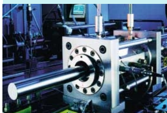
Rysunek 8 Urządzenie do testowania uszczelnień tłoczkowych
