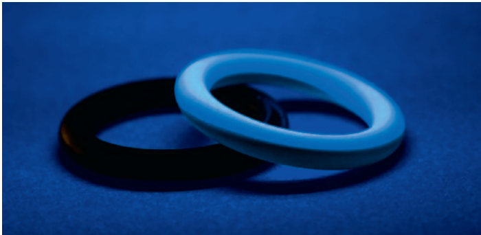
Unbeschichtete und beschichtete Dichtung unter UV-Licht
