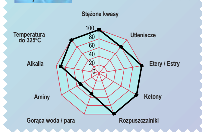
Radarowy wykres odporności chemicznej tworzywa Isolast® J9503
