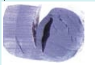
O-ring uszkodzony na skutek dekompresji wybuchowej
