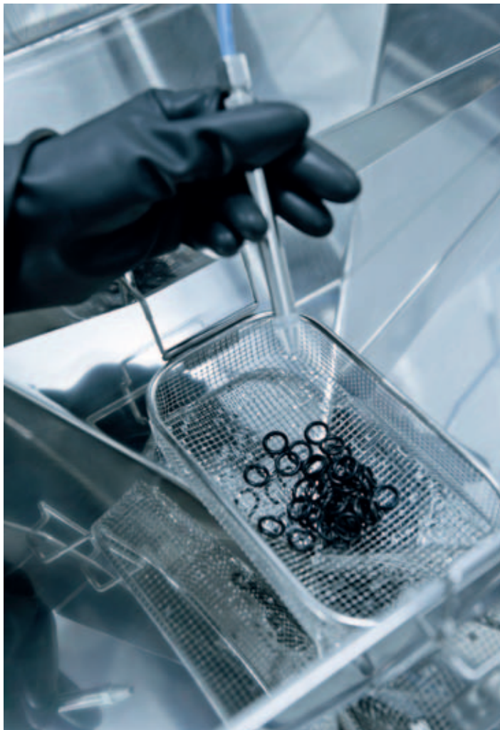
Prüfung von Dichtungen auf partikuläre Restverschmutzung mittels Spritzmethode nach ISO 16232
